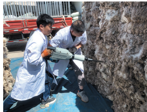
内蒙古纤维质量监测中心技术人员使用自主研发的钻芯杆
