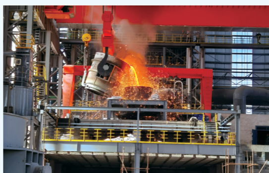
▲世界首创氢基熔融还原炼铁工艺在乌海市落地转化。
