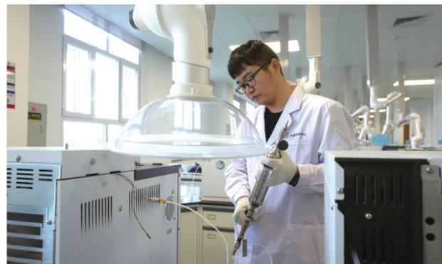
内蒙古久泰新材料科技股份有限公司研发人员正在进行MTBE单元一段加氢后的C4试验。
