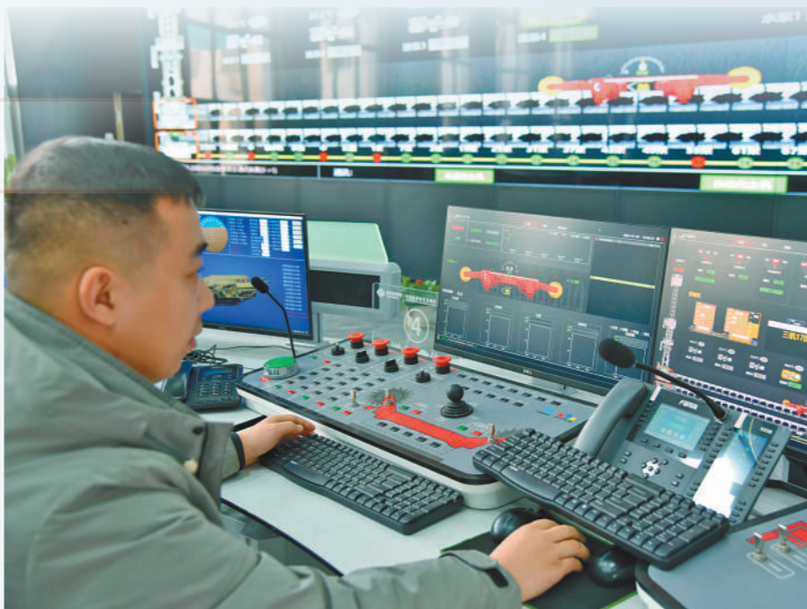
老石旦煤矿工作人员利用5G信号操控井下机械采煤。
