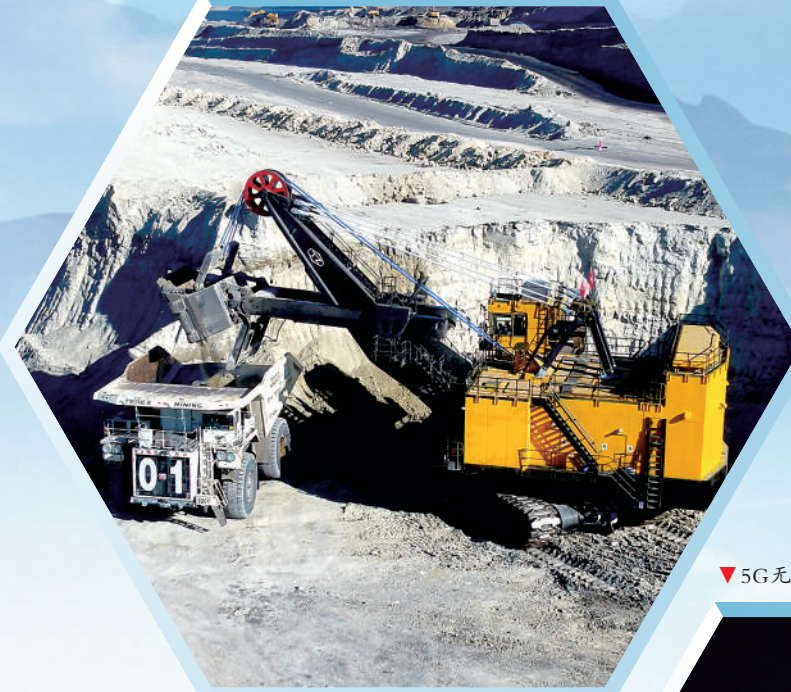
极寒工况5G+无人驾驶卡车自动对位装车。
