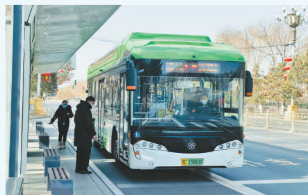
在乌海市,氢燃料电池公交车已上路运行。该公交车通过氢气和氧气的化学还原反应产生电,以电驱动汽车行驶,整个过程只产生电与水,达到零排放标准。 本报记者 郝颀 摄
