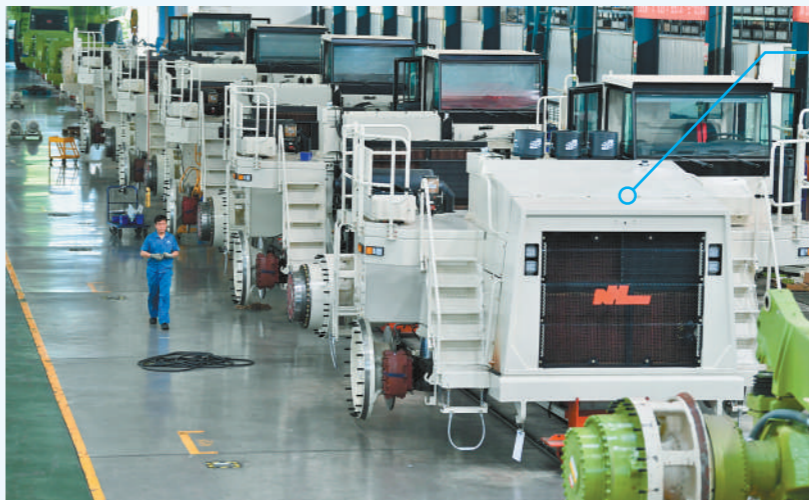
在内蒙古北方重型汽车股份有限公司矿用生产车车间,工人正在进行部件装配。该公司大力实施创新驱动战略,研发的双混合动力矿车NTE330、NH35混合动力矿车和TR50E纯电动矿车,推动矿用车辆动力多元化。 本报记者 孟和朝鲁 摄
