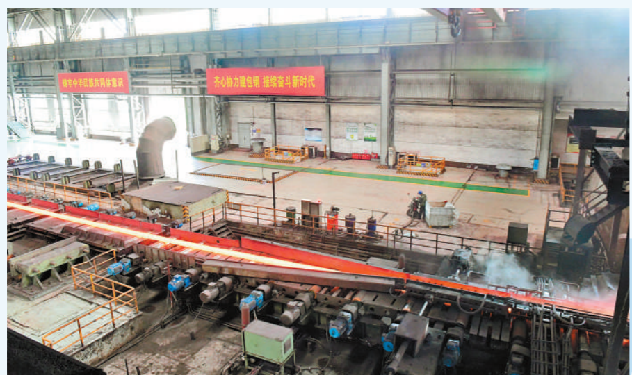
包钢轨梁厂二号大型万能轧钢生产线余热淬火钢轨生产现场一派繁忙。近年来,包钢正在不断加快技术创新步伐,加快由“一钢独大”的传统国企向稀土新材料等领域拓展。 本报记者 王磊 摄
