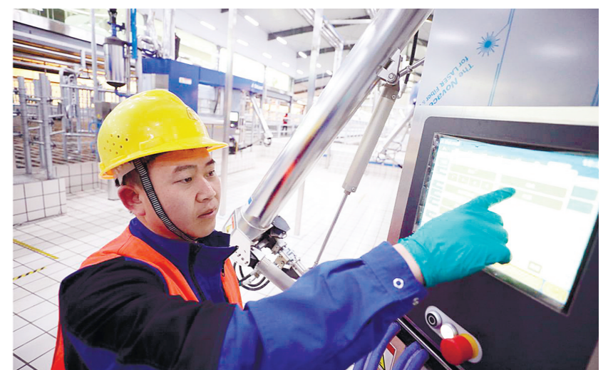
工作人员调试全智能无人挤奶机器人。 本报记者 刘墨墨 摄
