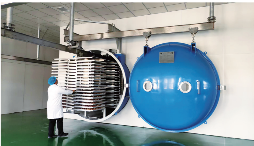
蒙果鲜食品有限公司员工将鲜果片装入真空干燥箱进行冻干处理。农产品保鲜储存过去是个“老大难”问题,如今,对于林西县新城镇农户来说,这已是分分钟就能解决的小事一桩。2021年果蔬气调保鲜库投用以
