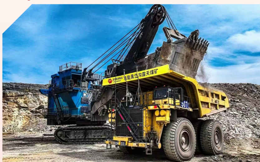
国能准能集团进行安全生产技术革新，使用无人驾驶矿车运载矿石矿渣。
