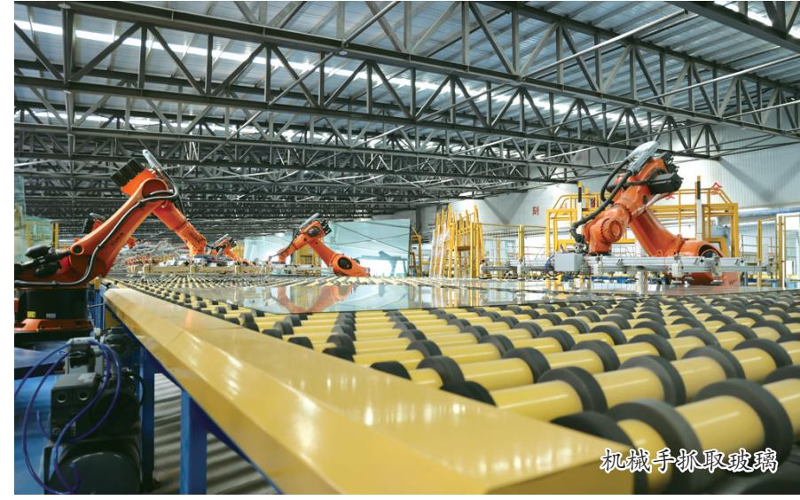
看到,整块的成品玻璃从生产车间由辊台传送到成品车间,自动化的切割机器按照设置好的参数对玻璃进行切割。一块块切割好的玻璃被带有吸盘的机械手抓起,放置在一旁的运送车上。最终,这些玻璃将被打包分装发往目的地。
