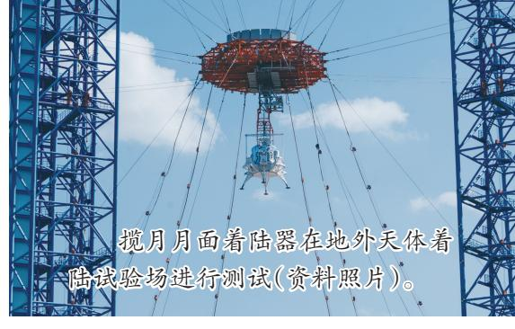
月面着陆器在地外天体着陆试验场进行测试(资料照片)。
