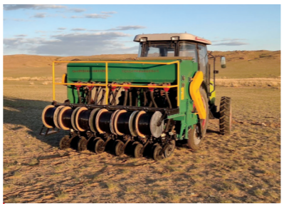
圆盘式免耕施肥水肥剂管理播种机助力生态治理。
